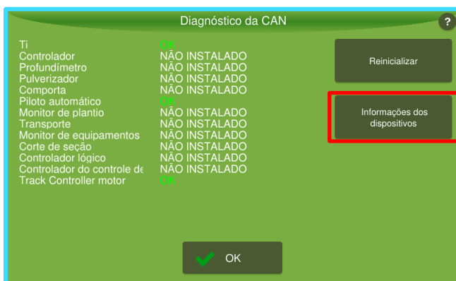
3° - Veja se está conectado "Piloto automático" e o "Track Controller motor" (OK), caso esteja N/C verifique as conexões.
